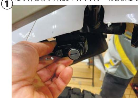
↓キャリヤステーとサブフレームの間にメインステーを割り込ませて上部取付穴位置を合わせた後、純正ボルトで仮止めします、後部取付穴にはアルミスペーサーをフレームとステーの間に入れ M8-25mm ボルトで仮止めします。
