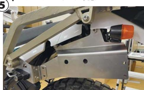
↓ステー類を固定後ツールボックス本体をボルトナット 4 本で取り付けていきます。
